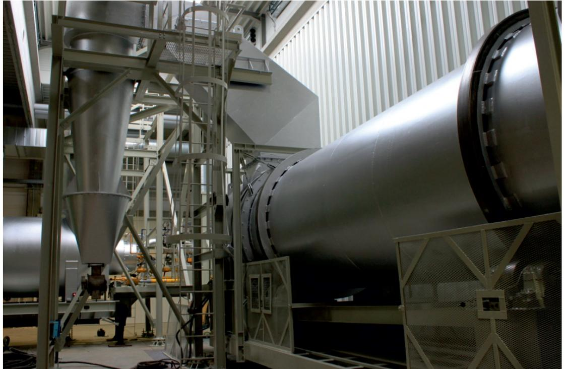
Foto: Drehrohr zur Behandlung verschiedener Hg- und metallhaltiger Abfallströme
