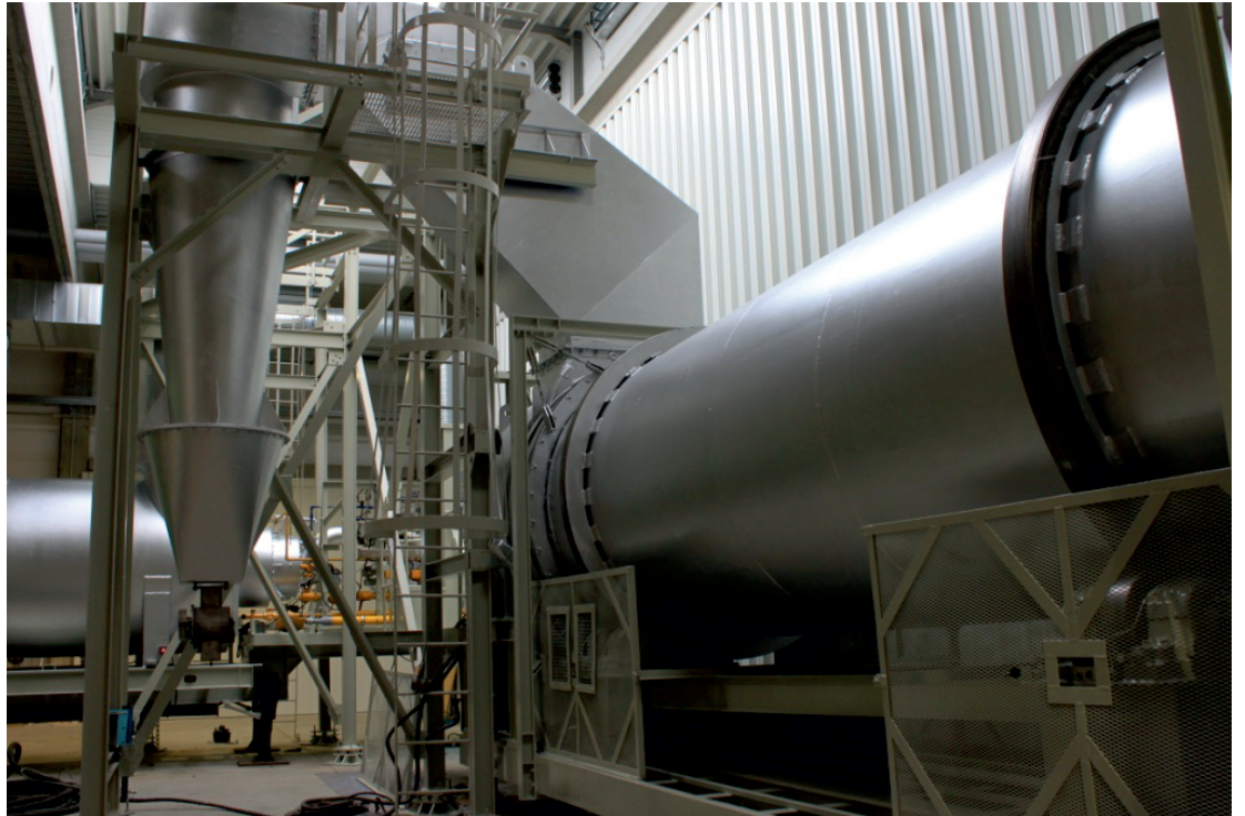
Foto: Drehrohr zur Destillation Hg-haltiger Abfälle
